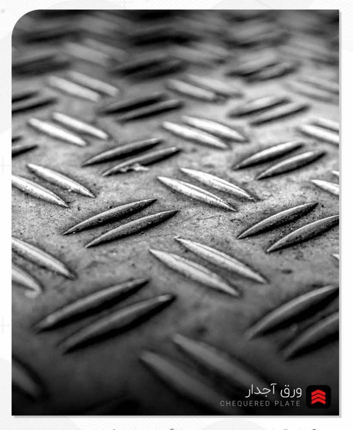
ورق آجدار ورقی است با سطحی برجسته با الگوهای منظم و یکنواخت نظیر لوزی و بادام که این برجستگیها به منظور کاهش اصطکاک بر روی ورق ایجاد میشود. عمده کاربرد این نوع ورق در صنایع نفت و گاز، پتروشیمی، ماشینسازی، راهسازی، معابر شهری و ساختمانی میباشد. معمولا در ضخامت ۲ الی ۱۰ میلیمتر عرضه میگردد.
