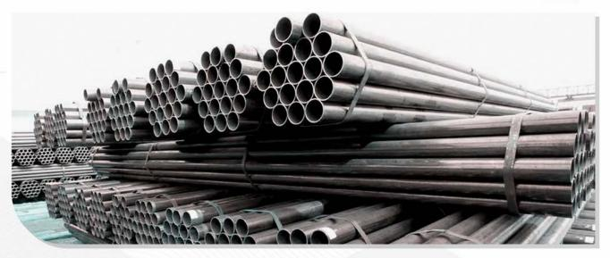
لوله درزدار به وسیله خم کردن ورق به شکل لوله و سپس جوشکاری روی آن به سه روش ERW، HFI و SAW ایجاد میشود. این نوع لوله به دلیل فناوری سادهتر در تولید به نسبت لوله بدون درز، ارزانتر بوده و معمولا در صنایع کشاورزی، غذایی، خودروسازی، انتقال آب و فاضلاب و مایعات غیر سمی کاربرد دارد.
