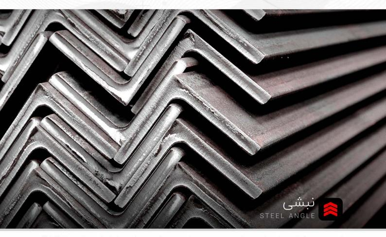
این نوع پروفیل مقطعی از دو ضلع عمود برهم ساخته میشود. نبشی ها با علامت اختصار L یا V به کار میروند. کاربرد آن جهت اتصالات پلها به ستونها، تیرآهنها به سیمهای باربر و اتصالات ستونها به صفحات درفوندانسیون و در آسانسورها میباشد. نبشیها دردو نوع بال مساوی و بال نامساوی معمولا به صورت فابریک یا پرسی ازسایز ۲۰ الی ۲۰۰ میلیمتر عرضه میگردند.
