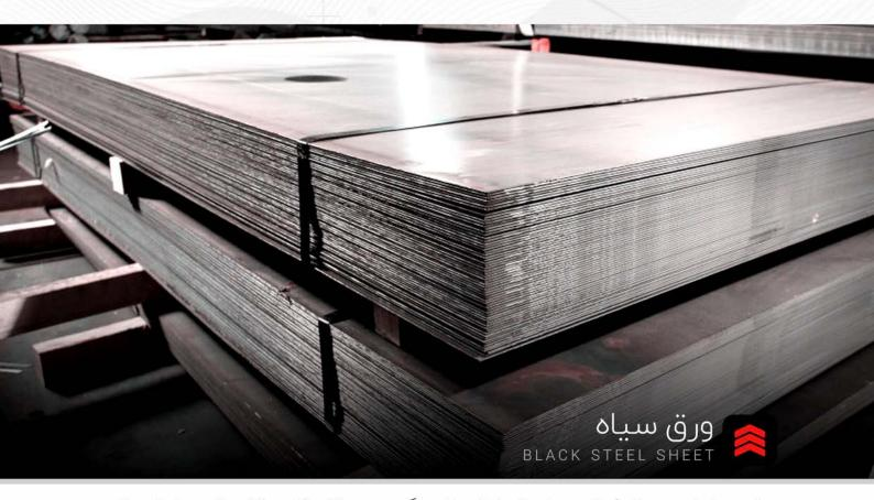
ورق سیاه نوعی ورق فولادی با روش تولید نورد گرم می باشد که پرکاربردترین نوع ورق در صنایع کشاورزی، ساختمانی، پتروشیمی، خودرو سازی، تانکرسازی و ... است. بنا به نیاز مشتری معمولا در ابعاد ۱۰۰۰ تا ۲۰۰۰ میلیمتر، به صورت شیت و رول (بدون محدودیت طولی در حالت رول) عرضه میگردد.
