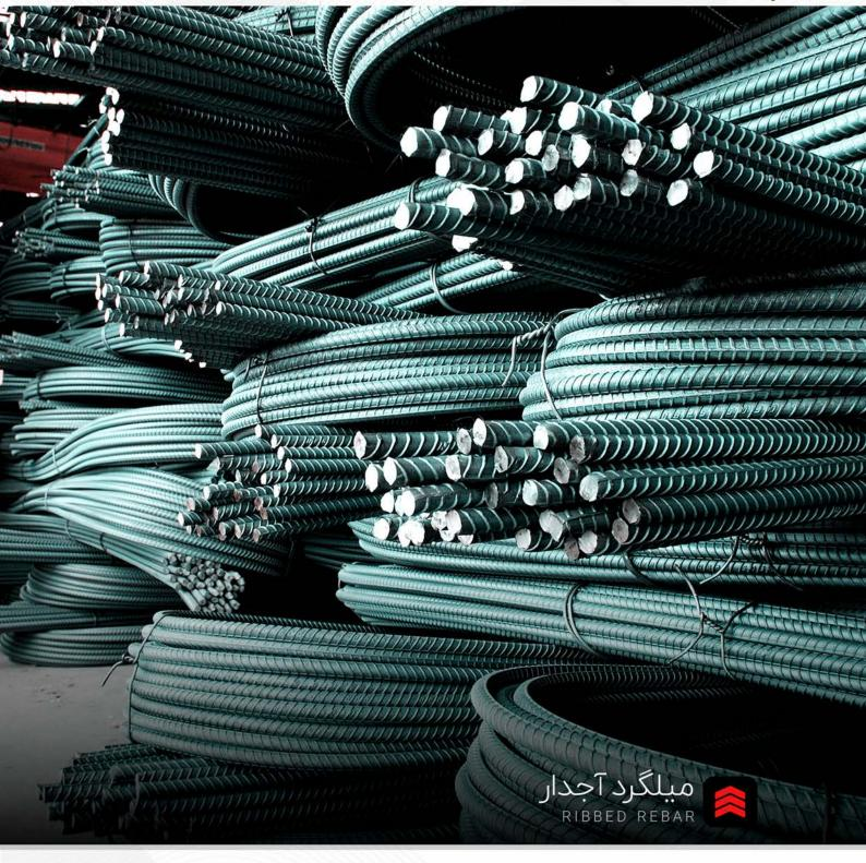
میلگرد نوعی میله فولادی است که در ضخامت و سایزهای متفاوتی ساخته میشود و عمدهترین کاربرد آن برای افزایش مقاومت کششی بتن در مقابل نیروهای وارد شده درون بتن (مسلح کردن بتن) در صنایع ساختمانسازی، سدسازی و ... میباشد. میلگردها در انواع ساده و آجدار تولید میشود. میلگرد ساده با عنوان A1 و میلگرد آجدار درسه نوع A2, A3, A4 میباشند. میلگرد آجدار به دلیل داشتن آج بر سطح میله، چسبندگی بیشتری در بتن ایجاد میکند و به سه صورت آج مارپیچی، جناغی و مرکب عرضه میگردند.
